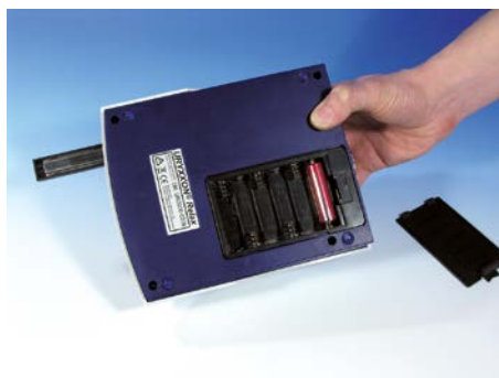
Fig. 11: logement des piles
