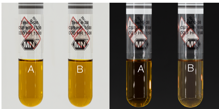
2 cuvetten (A | B) met dezelfde CZV-concentratie. De troebelheid in cuvette B beïnvloedt het resultaat met tot wel 30 %.
