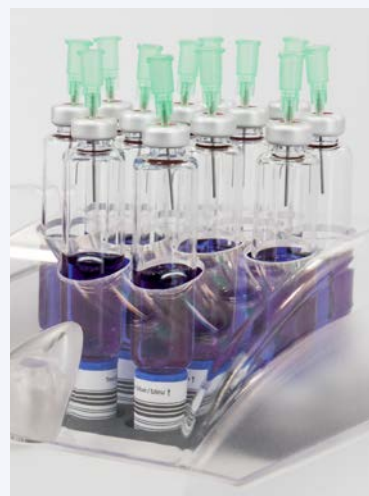
Oxydation en CO 2 du carbone organique présent dans l'échantillon.
