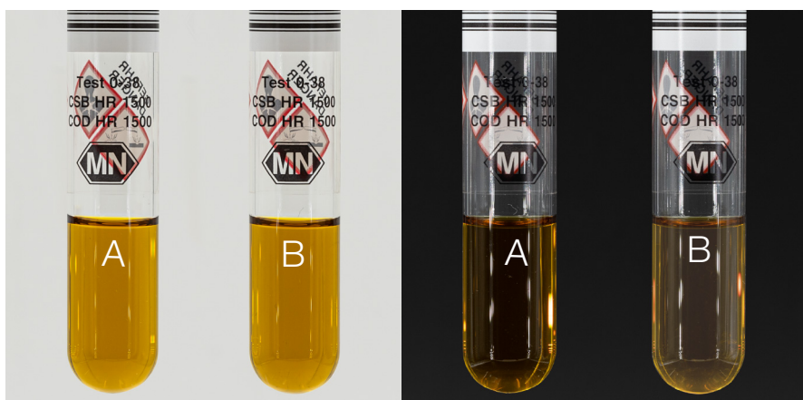
2 cubetas (A | B) con idéntica concentración de DQO. La turbidez en la cubeta B influye en el resultado en hasta un 30 %.
