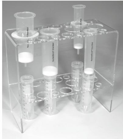
Figure 3 Montage des colonnes NucleoBond® Xtra Midi / Maxi sur le support NucleoBond® Xtra Combi Rack
