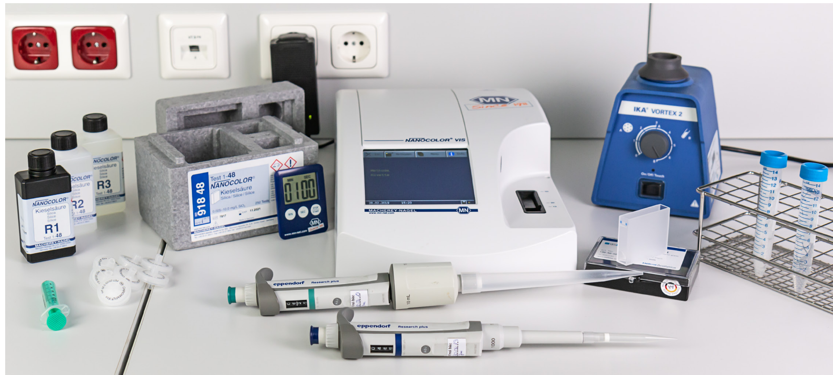
Abb. 1: Verwendetes Equipment für die photometrische Kieselsäurebestimmung
