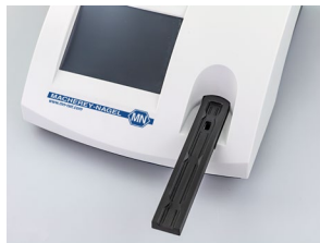
Fig. 18 : Vérifier l'alignement des encoches.
