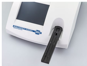
Pic. 18: Comprobación de la alineación de las muescas
