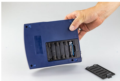
Pic. 15: Compartimento de pilas
