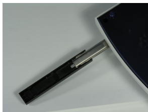
Pic. 16: Guía corrediza con soporte de tiras (vista inferior)
