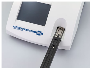
Abb. 17: Wiedereinsetzen des Teststreifenhalters
