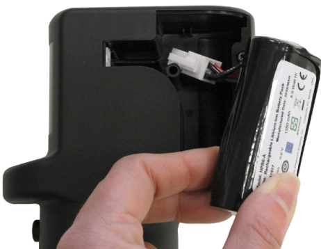
5. Schließen Sie den neuen Akku an und versichern Sie sich, dass die Steckverriegelung fest sitzt. Setzen Sie den Akku in das Gehäuse, notfalls unter Biegen der Kabel.
