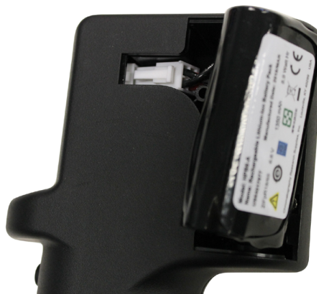
4. Drücken Sie die Steckverriegelung nach unten und entnehmen Sie den Akku.
