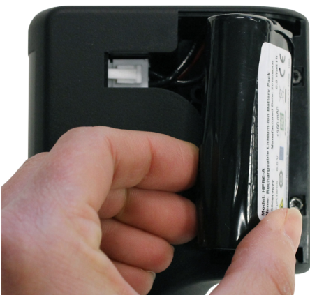
3. Entnehmen Sie den Akku samt angeschlossenem Kabel dem Gehäuse.
