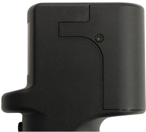
1. Lösen Sie die Schraube, die die Abdeckung des Akkus befestigt.
