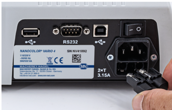
Figura 2: Inserción del fusible en el bloque térmico
