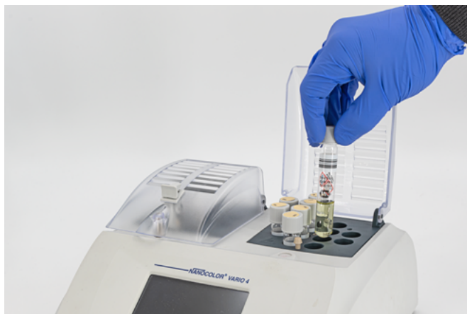
Figura 17: Extracción de las cubetas del bloque térmico
