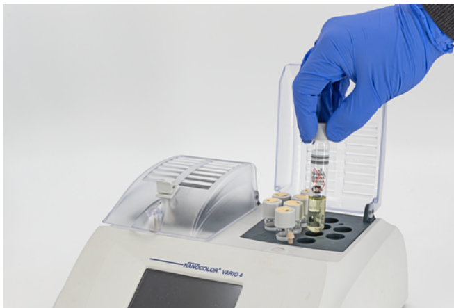
Abbildung 17: Entnehmen der Küvetten aus dem Thermoblock
