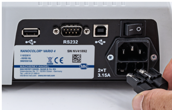
Abbildung 2: Einsetzen der Sicherung in den Thermoblock
