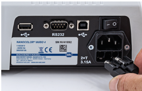
Figure 2 : Insertion du fusible dans le bloc chauffant.
