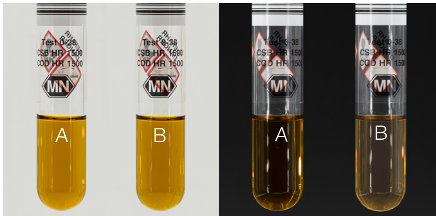
2 Küvetten (A | B) mit gleicher CSB-Konzentration. Die Trübung in Küvette B beeinflusst das Ergebnis um bis zu 30 %.
