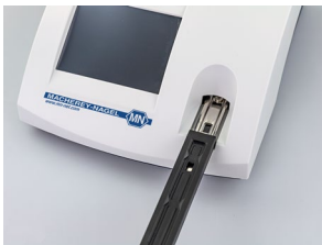
Fig. 17 : Remise en place du porte-langnette
