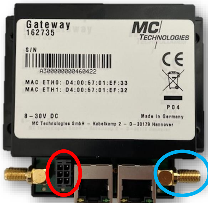
Bild 1: Netzwerkmodul Strom Anschluss
