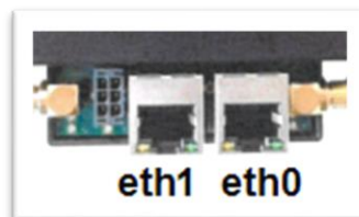
Bild 2: Ethernet Anschlüsse des Netzwerkmoduls
